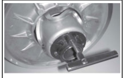
VARIAATTORIN AVAUSTYÖKALU MUOVISEN SÄÄTIMEN NAVASSA
