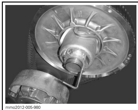
FORLENGER FOR DRIVREIMSKIVE MONTERT PÅ JUSTERINGSNAV
