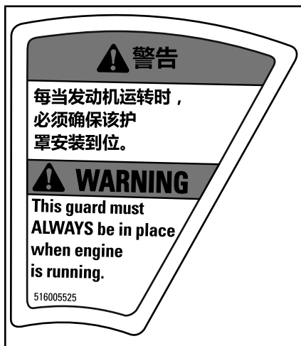
标签 16 - 位于制动盘护罩上 (上漆通道)
