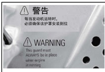
标签 16 - 位于制动盘护罩上（裸金属通道）
