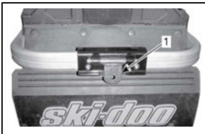
牵引挂接装置（扣环类型）
