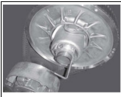
安装在调节器轮毂上的皮带盘扩展器
