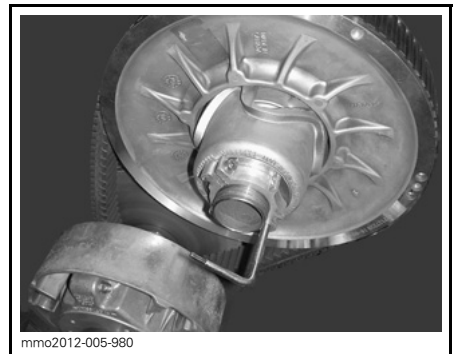
VARIATORUTVIDGARE INSTALLERAD PÅ JUSTERINGSNAVET
