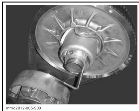
MANDRIN DE POULIE MENÉE INSTALLÉ SUR L'ANNEAU DE RÉGLAGE
