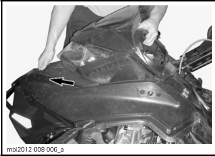
SKYV MOT FRONTEN
