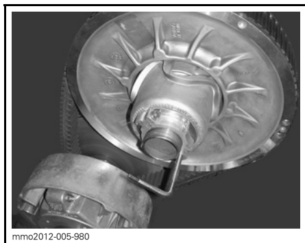
FORLENGER FOR DRIVREIMSKIVE MONTERT PÅ JUSTERINGSNAV
