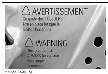
ÉTIQUETTE 9 - SUR LE PROTECTEUR DE DISQUE DE FREIN (TUNNEL EN MÉTAL NU)
