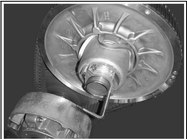
TYPEBILDE – FORLENGER FOR DRIVREIMSKIVE MONTERT PÅ JUSTERINGSNAV
