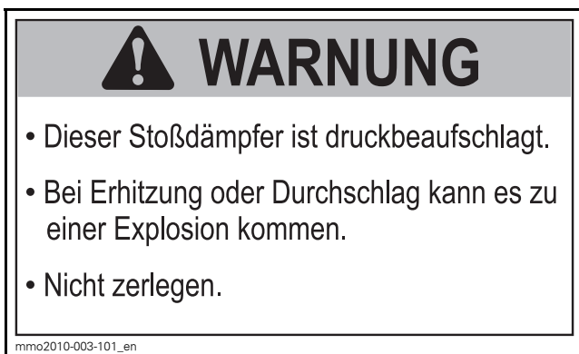
AUFKLEBER 12 - AUF GASDRUCKSTOßDÄMPFERN
