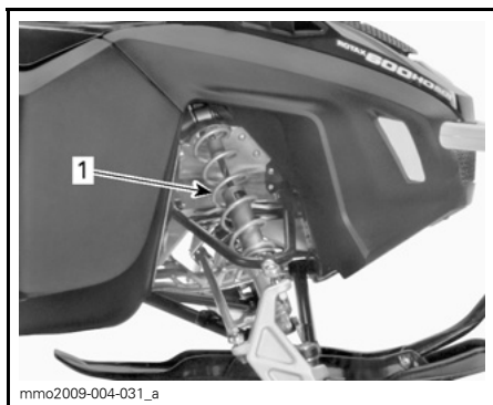
mmo2009-004-031_a TIPICO - SOSPENSIONI ANTERIORI 1. Molle anteriori per la guida
