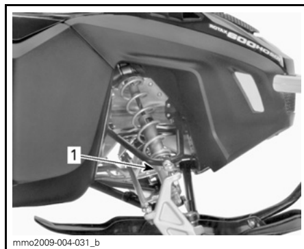
mmo2009-004-031_b TIPICO - PRECARICO CAMMA 1. Camma di regolazione
