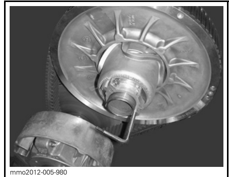
SCHEIBEN-EXPANDER AN NABE DER ALUMINIUM-EINSTELLVORRICHTUNG
