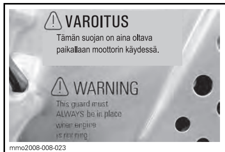
KILPI 16 - JARRULEVYN SUOJASSA (PELKKÄ METALLITUNNELI)
