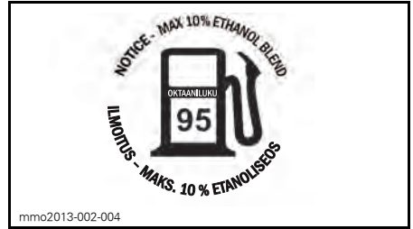
POLTTOAINESÄILIÖN KORKISSA - 600 HO E-TEC -MOOTTORISSA (MAISSA, JOISSA OKTAANILUOKITUS ON RON)
