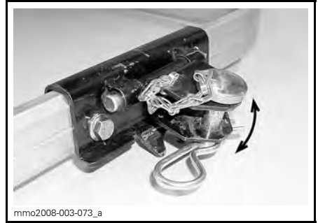
VETOKOUKKU LIIKKUU ESTEETTÖMÄSTI KUORMAA VEDETTÄESSÄ
