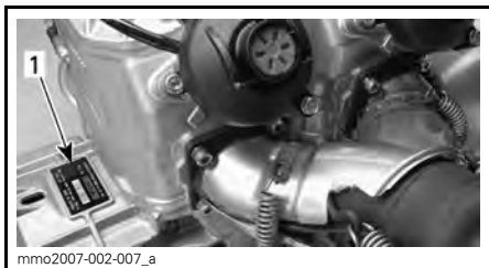
600 HO E-TEC -MOOTTORI 1. moottorin tunnistenumero
