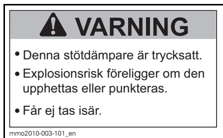
mmo2010-003-101_en DEKAL 15 - PÅ GASFYLLDA STÖTDÄMPARE
