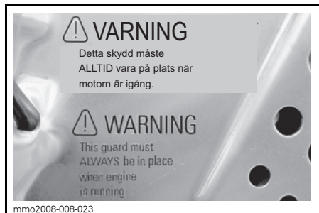
mmo2008-008-023 DEKAL 14 - PÅ BROMSSKÖLDEN (OFÄRGAD METALLTUNNEL)
