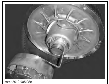
FORLENGER FOR DRIVREIMSKIVE MONTERT PÅ JUSTERINGSNAV
