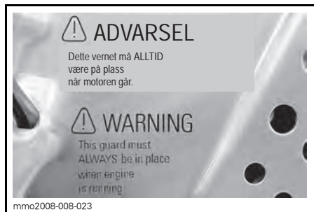
mmo2008-008-023 DEKAL 13 – PÅ BREMSEKIVEVERN (BART METALL PÅ TUNNEL)
