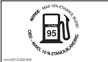
PLASSERT PÅ DRIVSTOFFTANKLOKKET - I LAND SOM BRUKER OKTANTALL RON
