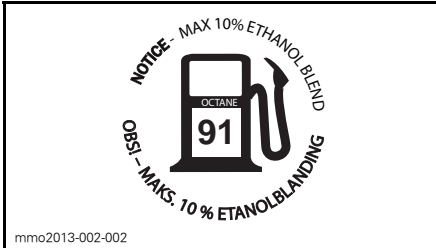
PLASSERT PÅ DRIVSTOFFTANKLOKKET - I LAND SOM BRUKER PUMPER MERKET MED OKTANTALL AKI (RON+MON)/2
