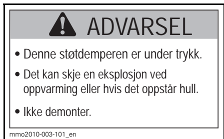
mmo2010-003-101_en DEKAL 14 – PÅ GASSTØTDEMPERE
