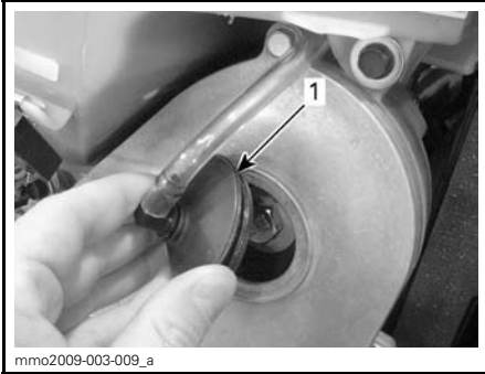
1. Bouchon de remplissage
