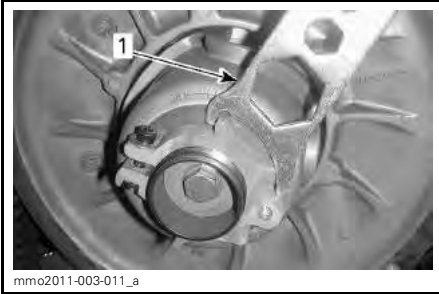
1. Outil de réglage de la suspension
