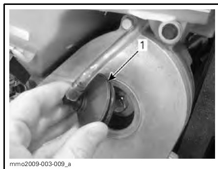
1. Bouchon de remplissage
