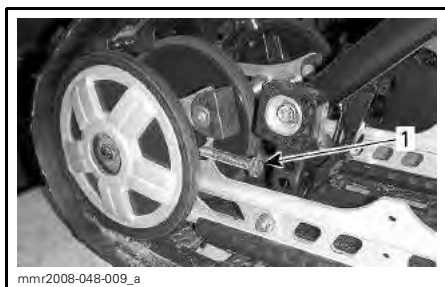
1. Vis de réglage droite
