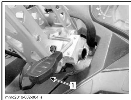
1. Levier de verrouillage du guidon inclinable
