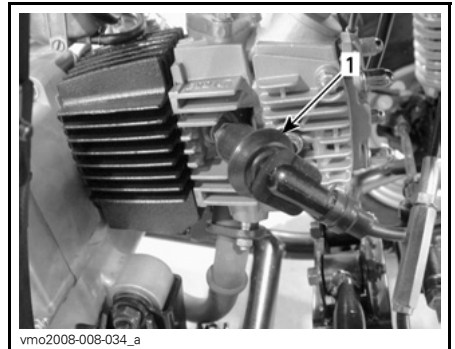
DESLIGUE O CABO DA VELA DE IGNIÇÃO 1. Cabo da vela de ignição
