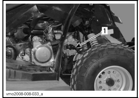
TÍPICO — LADO DIREITO DO VEÍCULO 1. Localização da vela e ignição
