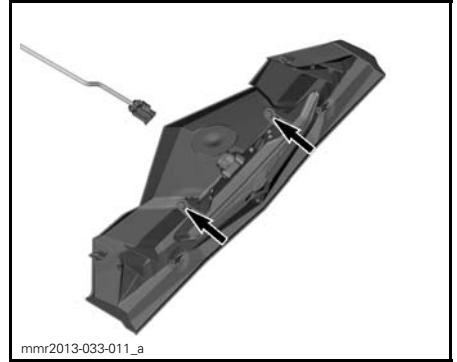
FÄSTSKRUVAR SOM HÅLLER FAST BAKLYKTAN I BAKLYKTSHÅLLAREN
