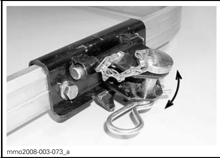
SLEPEKROKEN BEVEGER SEG FRITT UNDER SLEPING
