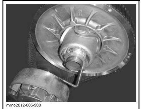
FORLENGER FOR DRIVREIMSKIVE MONTERT PÅ JUSTERINGSNAV
