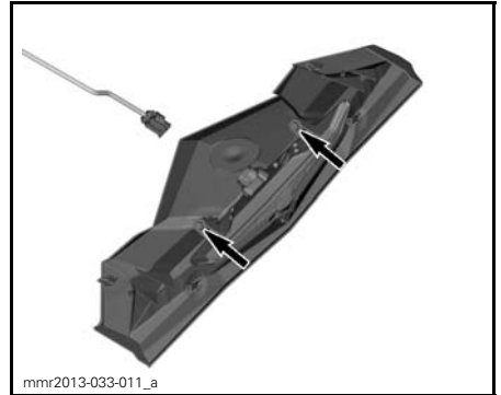
FJERNE SKRUENE SOM HOLDER BAKLYKTEN MOT BAKLYKTSTØTTEN
