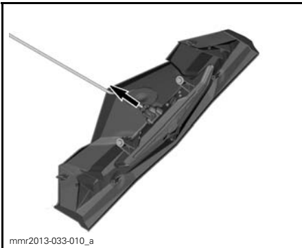
FRAKOBLING AV BAKLYSKONTAKTEN
