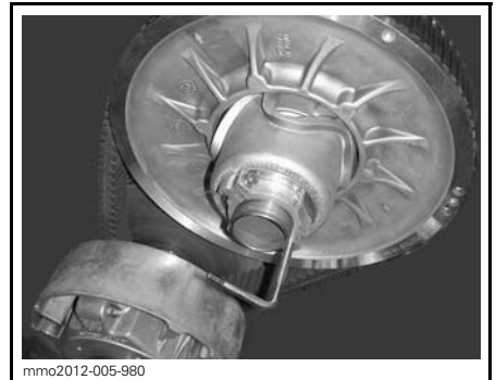
VARIATORNS UTVIDGARE INSTALLERAD PÅ JUSTERINGSNAVET
