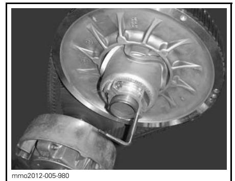
mmo2012-005-980 VARIAATTORIN AVAUSTYÖKALU ASENETTUNA SÄÄTIMEN NAPAAN
