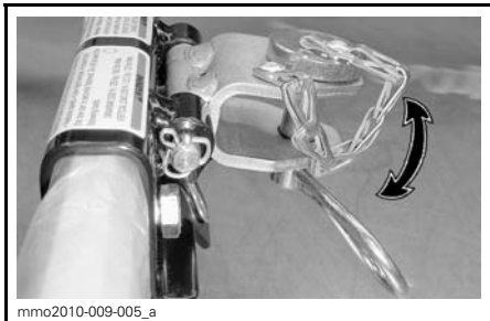
mmo2010-009-005_a DRAGKROKEN RÖR SIG FRITT VID BOGSERING
