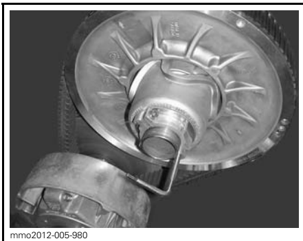
VARIATORNS UTVIDGARE INSTALLERAD PÅ JUSTERINGSNAVET
