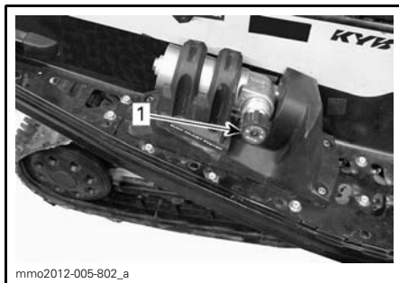
1. Bouton pour régler la compression à basse ou à haute vitesse
