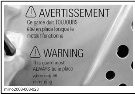
ÉTIQUETTE 14 - SUR LE PROTECTEUR DE DISQUE DE FREIN (TUNNEL EN MÉTAL NU)
