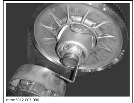
mmo2012-005-980 VARIAATTORIN AVAUSTYÖKALU ASENETTUNA SÄÄTIMEN NAPAAN
