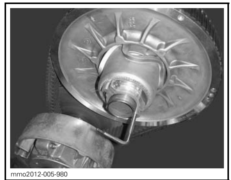
VARIATORNS UTVIDGARE INSTALLERAD PÅ JUSTERINGSNAVET
