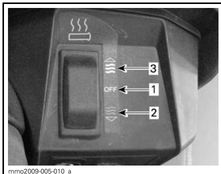
1. Pois päältä 2. Lämmin 3. Kuuma
