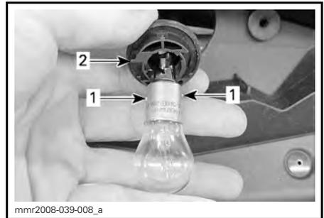
1. Tiges de verrouillage de l'ampoule
