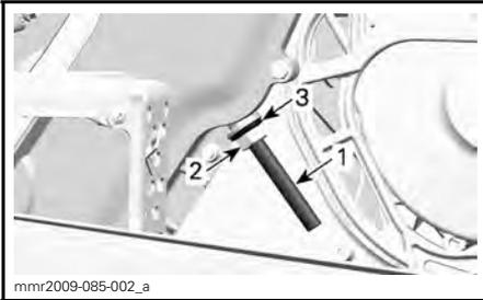
1. Vis de réglage du tendeur de chaîne
