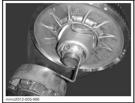
**PULLEY EXPANDER INSTALLED ON ADJUSTER HUB**
