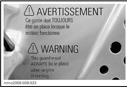
LABEL 10 - ON BRAKE DISC GUARD (BARE METAL TUNNEL)
