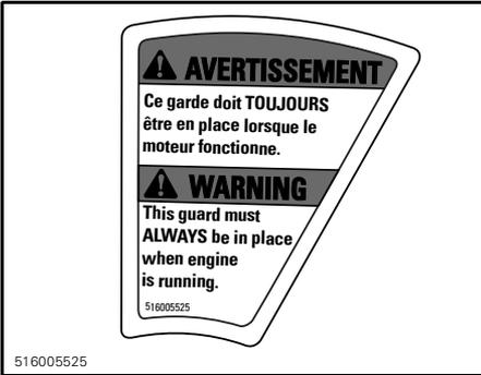
LABEL 10 - ON BRAKE DISC GUARD (PAINTED TUNNEL)
