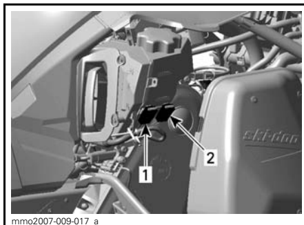
TYPEBILDE – HØYRE SIDE AV MOTORROM 1. 25 A ladesystemsikring 2. 5 A start/REK-sikring
