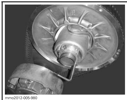
VARIATORNS UTVIDGARE INSTALLERAD PÅ JUSTERINGSNAV I ALUMINIUM
