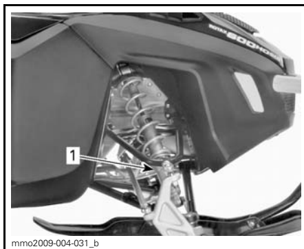
TYPBILD - FÖRSPÄNNING AV KAMTYP 1. Justeringskam
