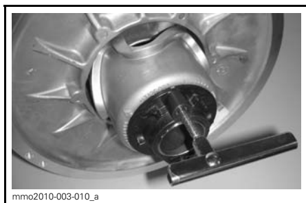
VARIATORNS UTVIDGARE INSTALLERAD PÅ JUSTERINGSNAV I PLAST
