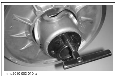
VARIAATTORIN AVAUSTYÖKALU MUOVISEN SÄÄTIMEN NAVASSA
