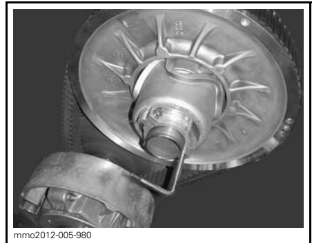
VARIAATTORIN AVAUSTYÖKALU ASENNETTUNA SÄÄTIMEN NAPAAN
