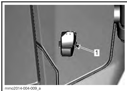
TIPICO - LATO SINISTRO DEL SERBATOIO 1. Interruttore di selezione delle modalità
