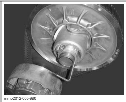
VARIAATTORIN AVAUSTYÖKALU ASENNETTUNA SÄÄTIMEN NAPAAN
