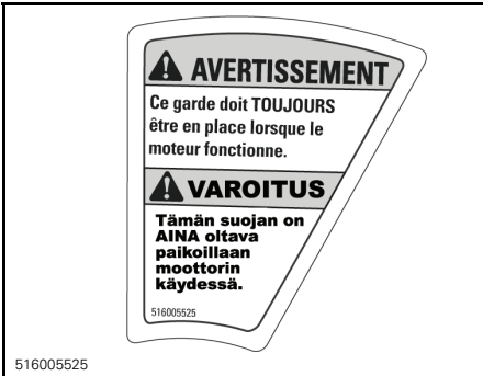
KILPI 14 - JARRULEVYN SUOJASSA (MAALATTU TUNNELI)
