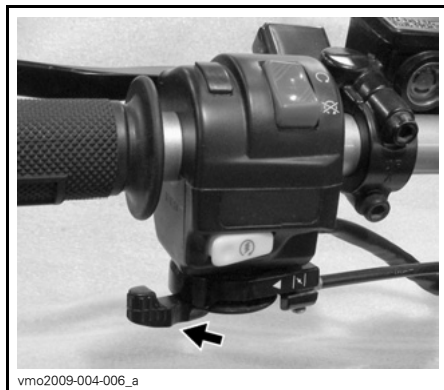
ESTRANGULADOR DE AIRE TOTALMENTE ABIERTO
