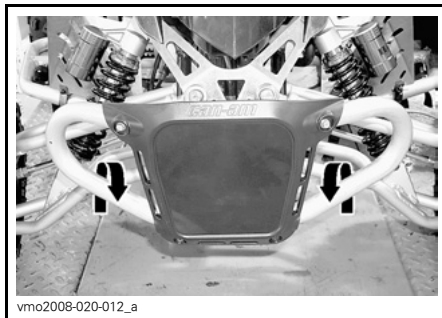
DS 90 X — UBICACIÓN DE LA FIJACIÓN DELANTERA
