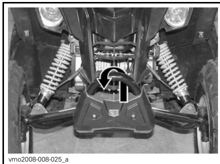
DS 70/DS 90 — UBICACIÓN DE LA FIJACIÓN DELANTERA
