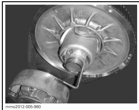
VARIATORNS UTVIDGARE INSTALLERAD PÅ JUSTERINGSNAVET
