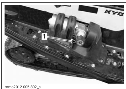
1. Knopp for å justere kompresjonsdemping ved lav/høy hastighet
