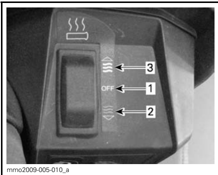
1. Bryter for varmehåndtak for passasjer
