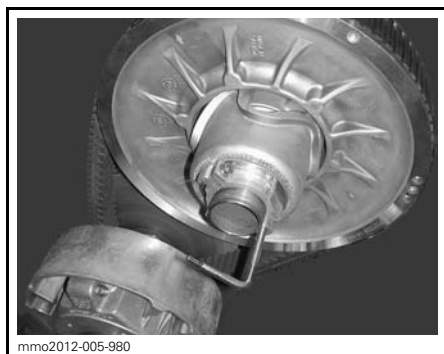
FORLENGER FOR DRIVREIMSKIVE MONTERT PÅ JUSTERINGSNAV
