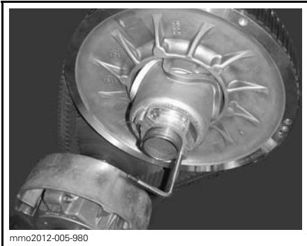
VARIAATTORIN AVAUSTYÖKALU ASENETTUNA SÄÄTIMEN NAPAAN
