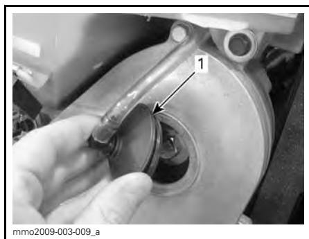
1. Bouchon de remplissage
