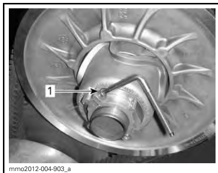
TYPIQUE 1. Boulon de serrage
