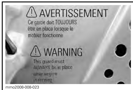
ÉTIQUETTE 13 - SUR LE PROTECTEUR DE DISQUE DE FREIN (TUNNEL EN MÉTAL NU)
