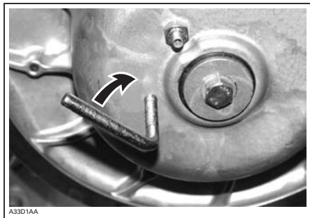
VARIAATTORIHIHAN ASENNUKSEEN KÄYTTÄMÄN IRROTUSTYÖKALUN KUVA.
