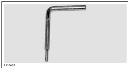
VARIAATTORIHIHAN ASENNUKSEEN KÄYTTÄMÄN IRROTUSTYÖKALUN KUVA.
