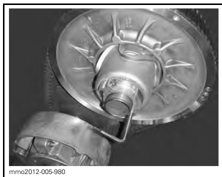
MANDRIN DE POULIE MENÉE SUR UN DISPOSITIF DE RÉGLAGE EN ALUMINIUM
