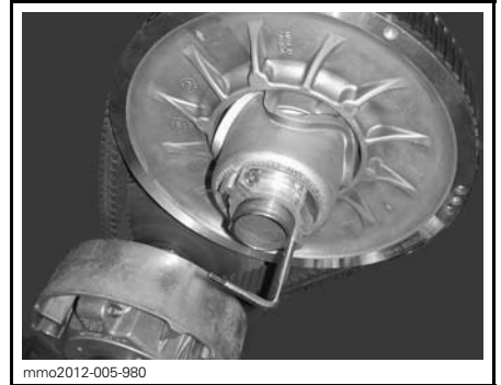
VARIAATTORIN AVAUSTYÖKALU ALUMIINISEN SÄÄTIMEN NAVASSA
