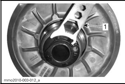
MUOVINEN SÄÄTIMEN NAPA 1. Jousituksen säätötyökalu
