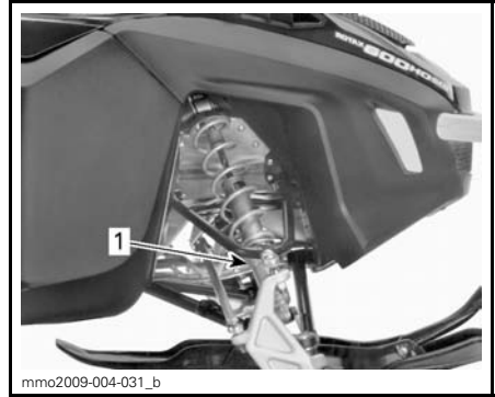
ESIMERKKI - SÄÄTÖNOKKATYYPPIINEN ESIJÄNNITYS 1. Säätönokka
