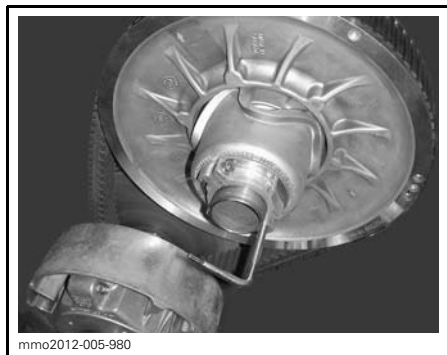
mmo2012-005-980 OUTIL D'ÉCARTEMENT DE POULIE MENÉE INSTALLÉ SUR L'ANNEAU DE RÉGLAGE
