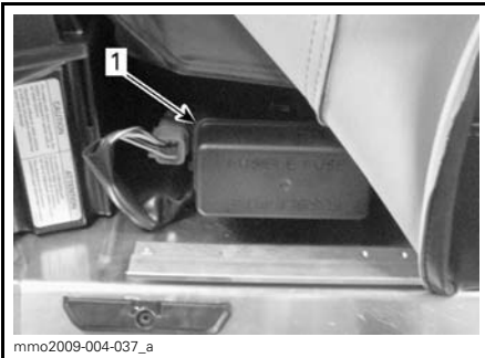
1. Boîte à fusibles
