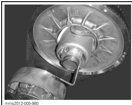
MANDRIN DE POULIE MÈNÉE INSTALLÉ SUR LE DISPOSITIF DE RÉGLAGE
