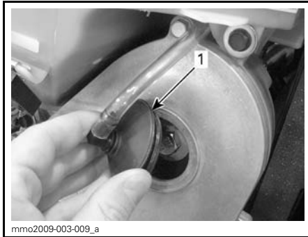
1. Bouchon de remplissage
