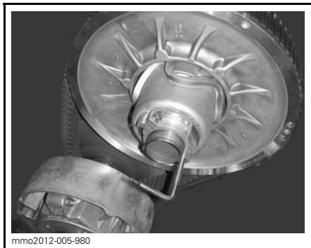
VARIAATTORIN AVAUSTYÖKALU ASENNETTUNA SÄÄTIMEN NAPAAN
