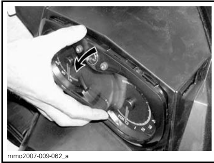
TIRER SUR L'AMPOULE ET LA REMPLACER
