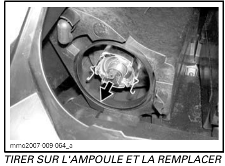
TIRER SUR L'AMPOULE ET LA REMPLACER
