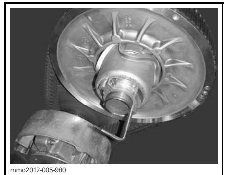
FORLENGER FOR DRIVREIMSKIVE MONTERT PÅ JUSTERINGSNAV
