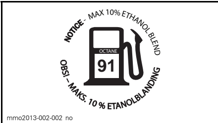
PLASSERT PÅ LOKKET FOR DRIVSTOFFTANKEN – PÅ ALLE MOTORER UNNTATT 600-MOTORER (I NORD-AMERIKA)
