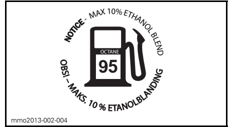
PLASSERT PÅ LOKKET FOR DRIVSTOFFTANKEN – PÅ ALLE MOTORER UNNTATT 600-MOTORER (UTENFOR NORD-AMERIKA)
